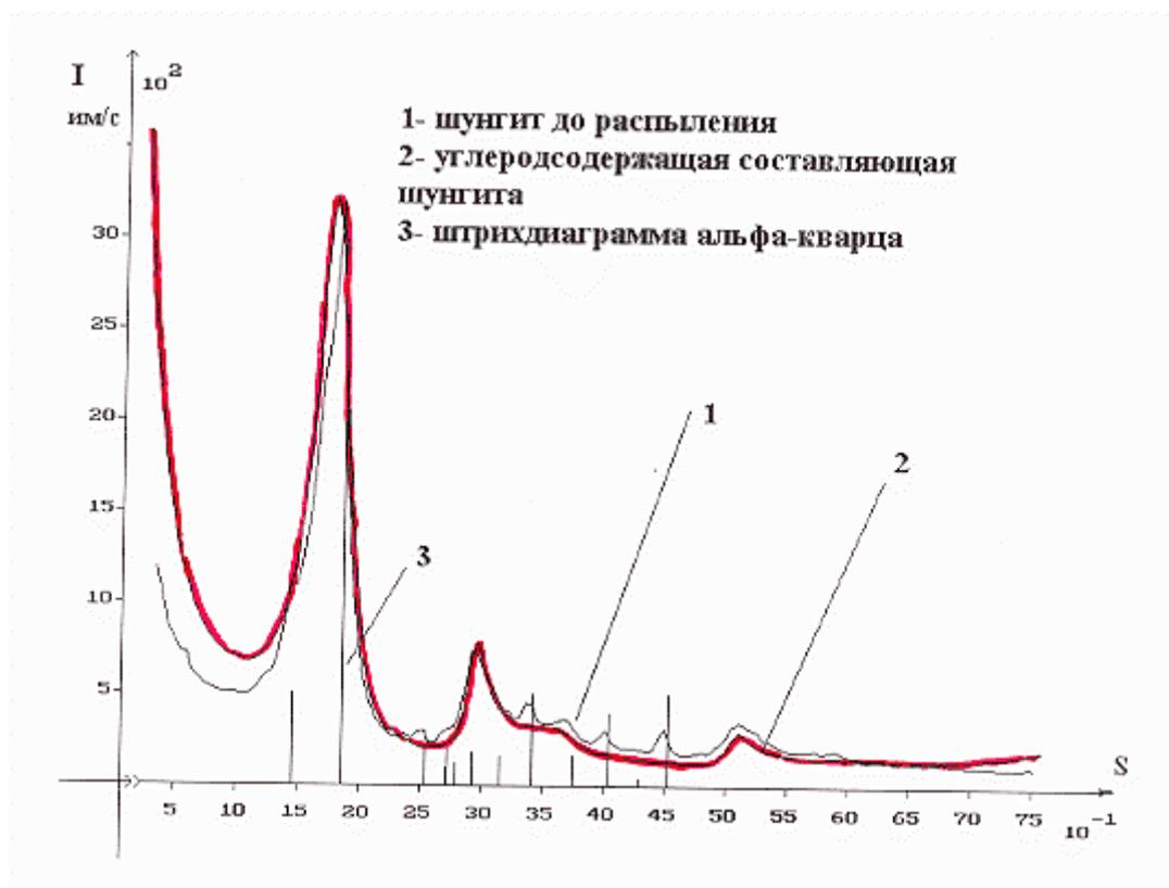
Рис. 21. Рентгенограммы: 1 – до распыления, 2 – углеродсодержащая составляющая шунгита; 3 – штрихдиаграмма  $\alpha$ -кварца
