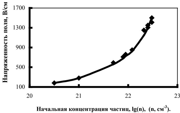
Рис. 23. Зависимость напряженности поля в канале дуги от начальной концентрации частиц
